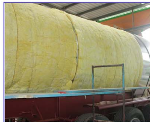
油罐車玻璃棉保溫外加龜甲網包覆
