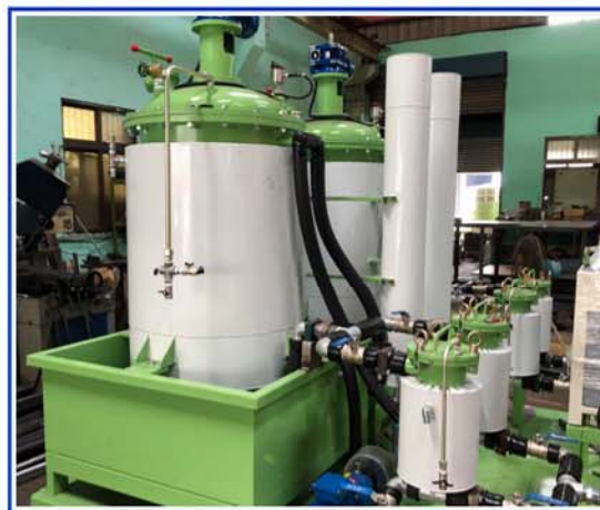
冰水設備保溫外覆烤漆板板金
