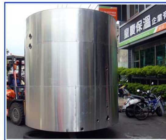
熱水桶隔熱保溫外覆鋁皮板金
