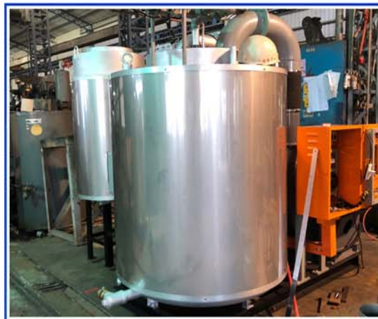
鍋爐保溫外覆不鏽鋼板板金
