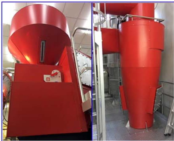
漏料桶設備保溫外覆烤漆板板金
