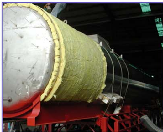
油罐車玻璃棉保溫外覆鋁皮板金
