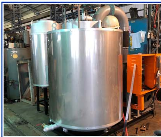
鍋爐保溫外覆不鏽鋼板板金
